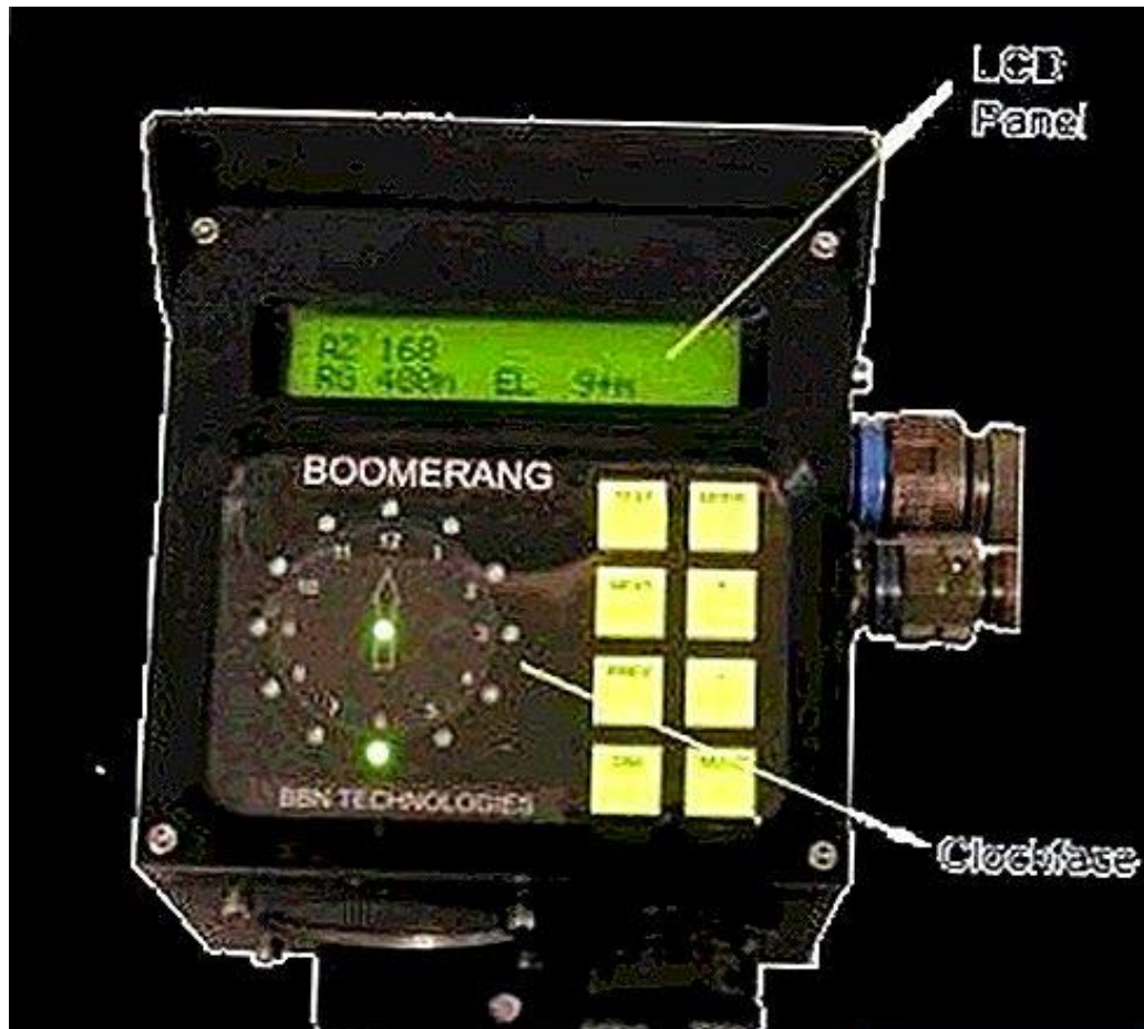
Рисунок 1.5 — Датчик системи Boomerang Warrior-X
