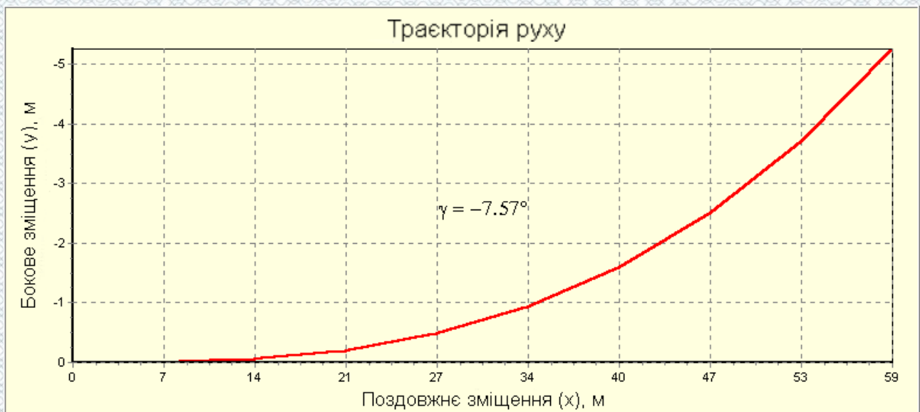
Рисунок 3.1 – Зміна координати траєкторії руху центра мас автомобіля та величина розвороту його поздовжньої осі при гальмуванні
