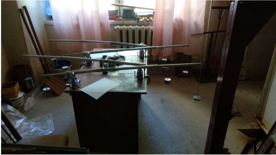
Рисунок 2.5 – Проведення компресійних випробувань
