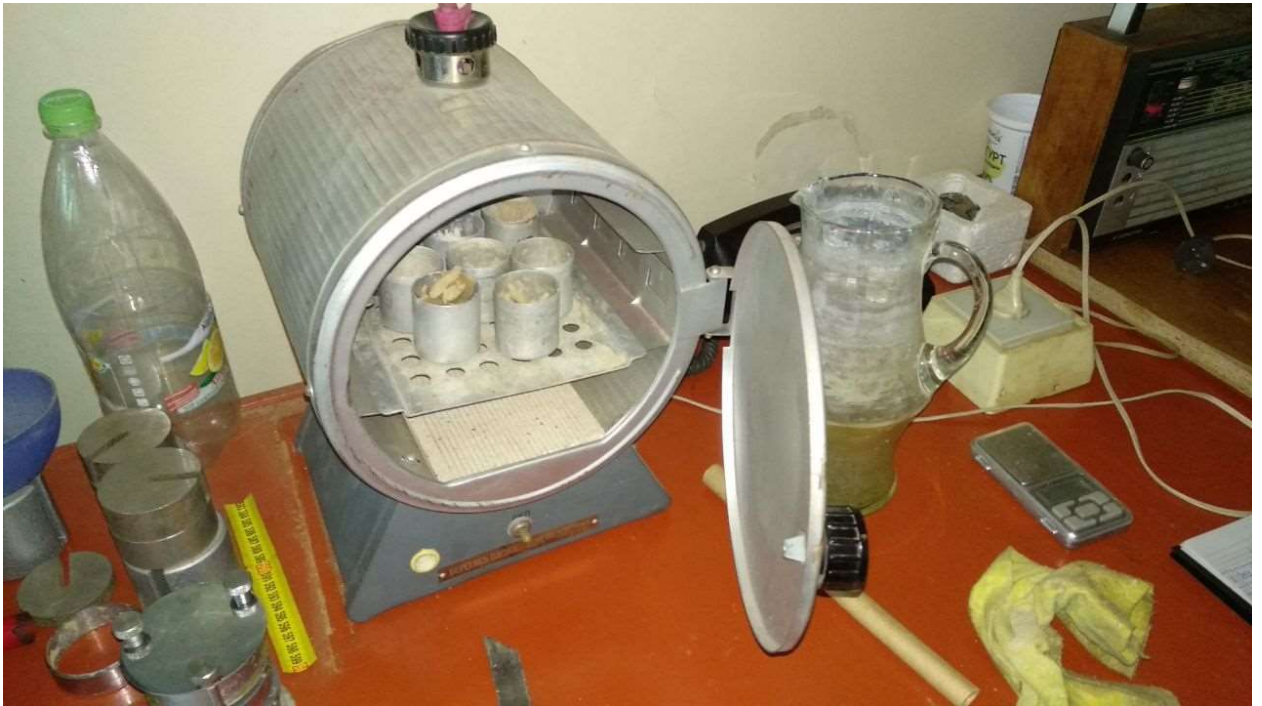
Рисунок 2.3 – Бюкси з ґрунтом в сушильній шафі
