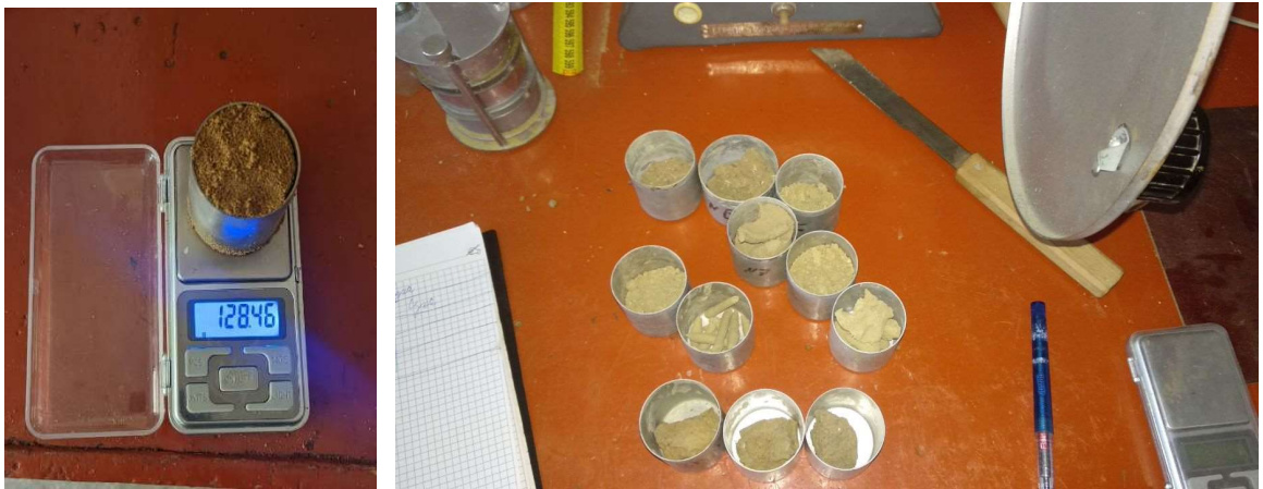
Рисунок 2.4 – Ваговий контроль щільності та границь пластичності ґрунтів
