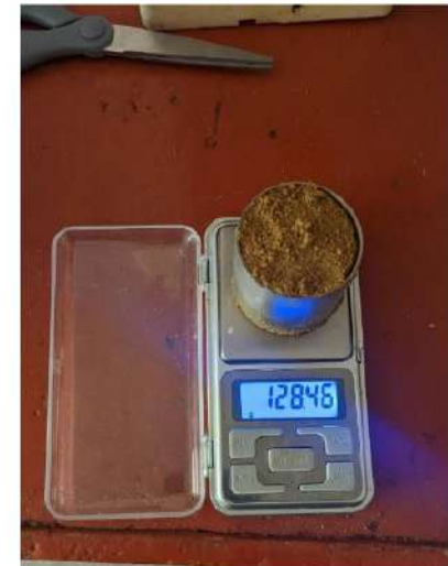
Ваговий контроль щільності ґрунтів
