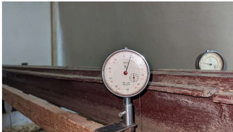
Рисунок 2.3 – Монтаж прогиноміру до стінок лотка
