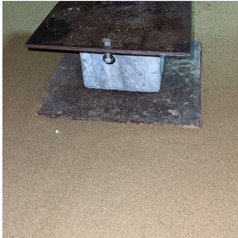
Рисунок 2.10 – Модель фундаменту з підсиленням банкетами в зверху, зануреного в котлован зі зворотньою засипкою та ущільненням
