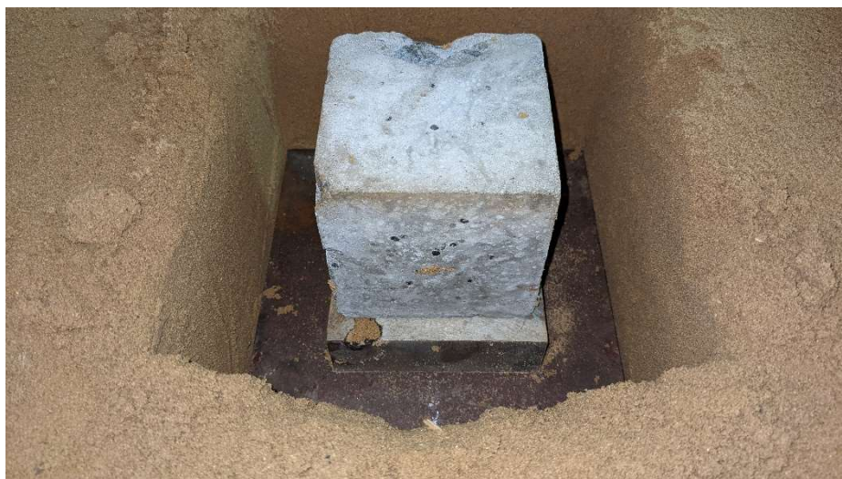
Рисунок 2.6 – Модель фундаменту з підсиленням в рівні підшви фундаменту
