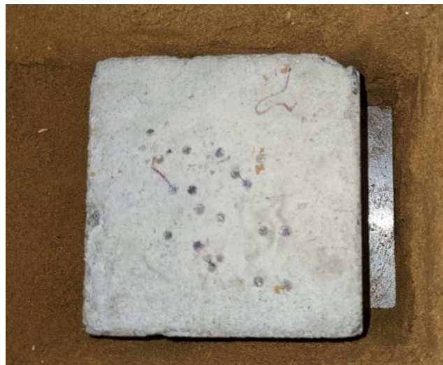
Рисунок 2.4 – Модель фундаменту без підсилення зануреного в котлован
