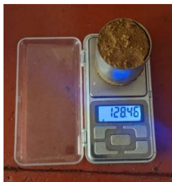
Рисунок 2.2 – Ваговий контроль щільності ґрунту
