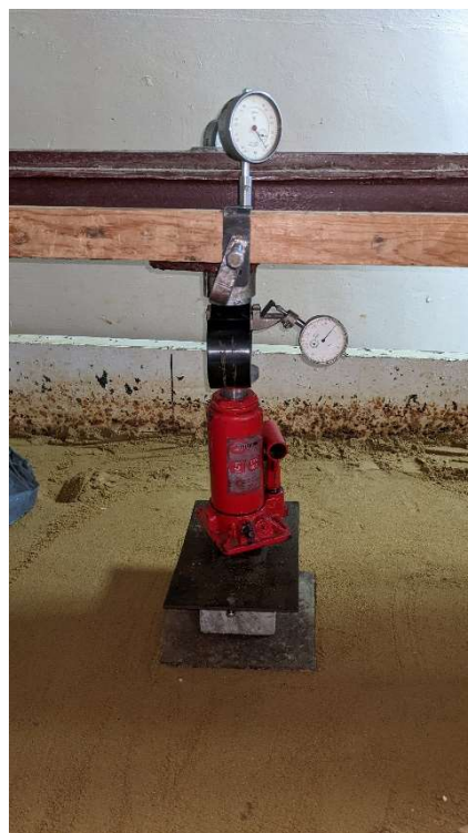
Рисунок 2.11– Модель фундаменту, підсиленого банкетами зверху перед випробовуванням
