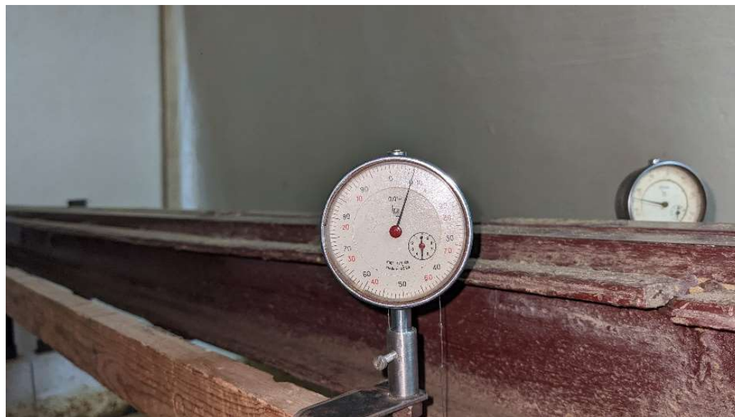
Монтаж прогиноміру до стінок лотка
