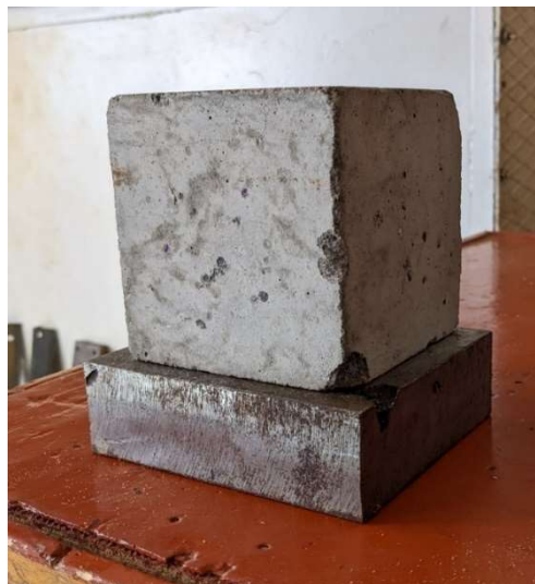
Рисунок 2.15 – Модель фундаменту без підсилення
