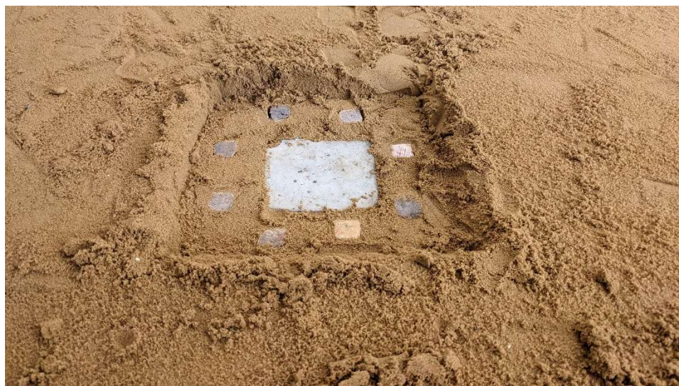
Рисунок 9.13 – Модель фундаменту з підсиленням палями зверху зануреного в котлован зі зворотньою засипкою та ущільненням
