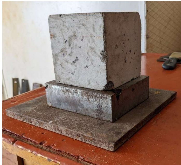
Рисунок 2.6 – Модель фундаменту з підсиленням в рівні підшви фундаменту
