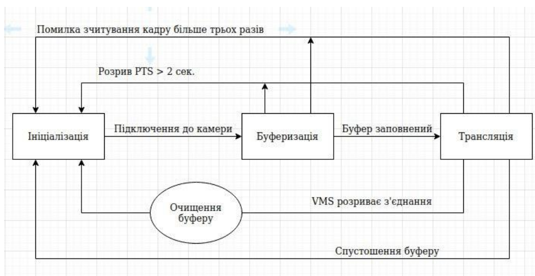
Рисунок 2.3 — Схема механізму перепідключення RTSP-компоненту
