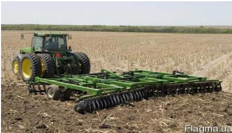
Рисунок 1.16 – Боронування трактором New Holland T 8050, дискова борона Great plains 3326 DH (глибина обробітку до 22 см. Робоча ширина 7,9 м.).
