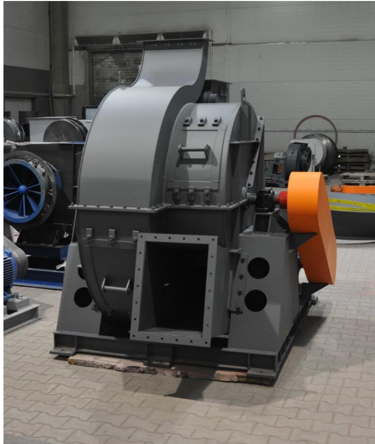
Рисунок 1.3 – Димосмок ДП-12 для очистки повітря від продуктів згорання палива разом із пилом інертних матеріалів
