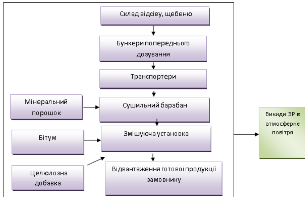
Рисунок 3.2 – Блок-схема основного виробництва
