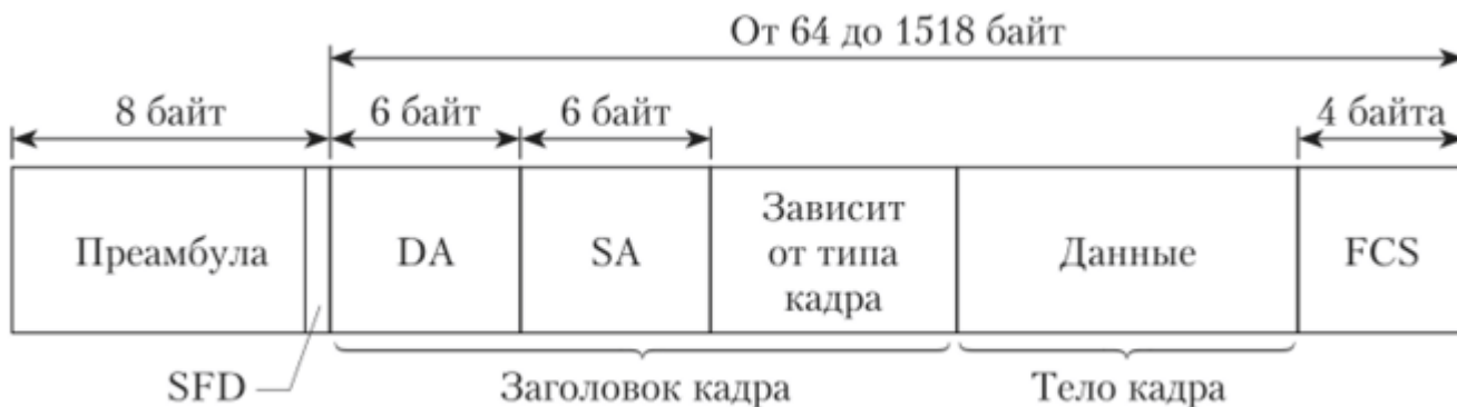
Рисунок 2.2 — формат кадру Ethernet
