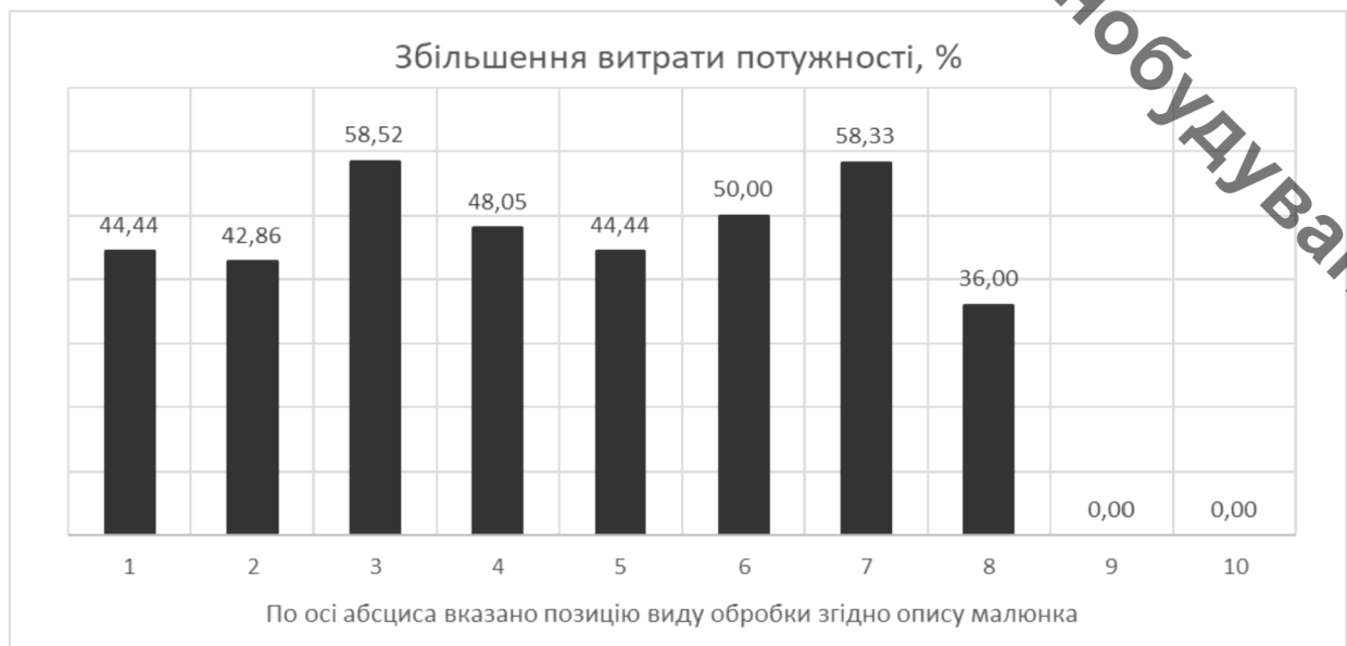
Рисунок 3.2 – Покращення продуктивності а) та збільшення витрати потужності б) для шпинделя 1,5 кВт на фрезерно-гравірувальному верстаті з ЧПК в порівнянні із роботою цього верстата для шпинделя 300 Вт
