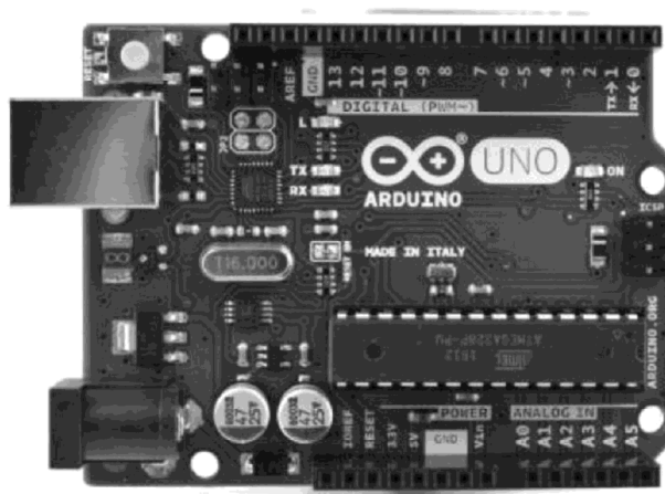
Рисунок 2.11 – Плата керування Arduino UNO моделі ATmega328
