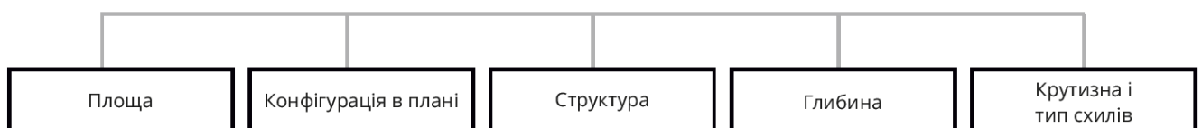
Рисунок 3.4 – Основні геометричні параметрами кар'єру, опрацювання автора
