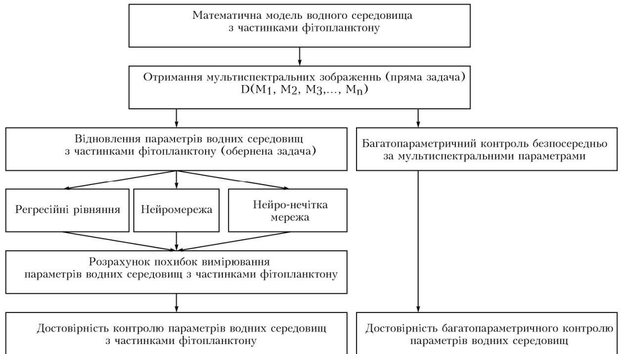
Рисунок 2.2 – Схема оцінювання достовірності мультиспектрального контролю параметрів забруднення водних середовищ
