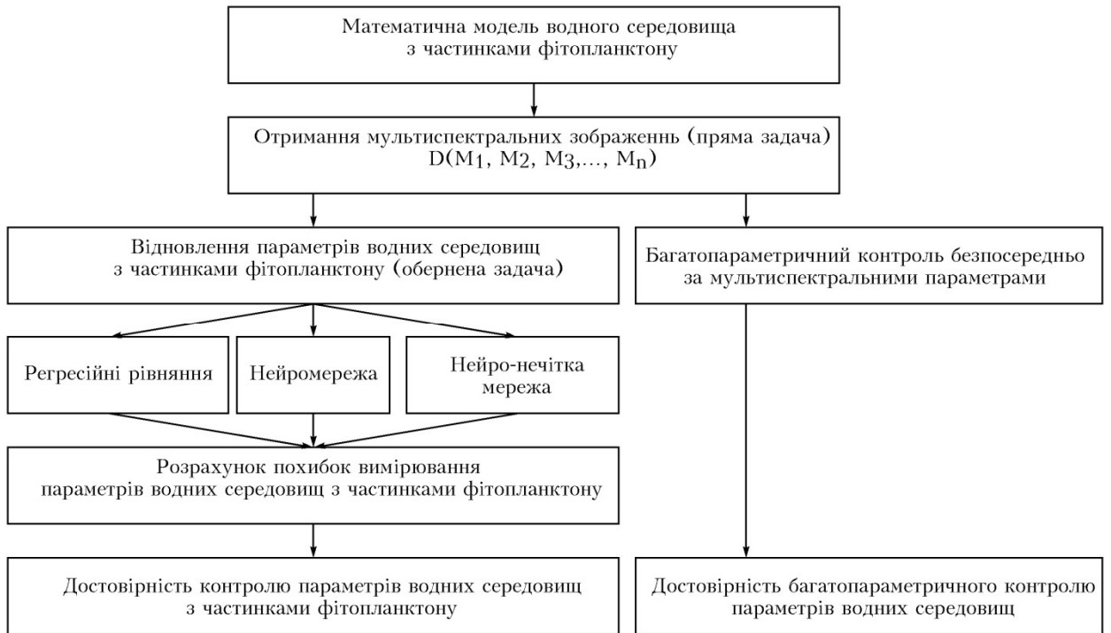
Рисунок В.3. Схема оцінювання достовірності мультиспектрального контролю параметрів забруднення водних середовищ
