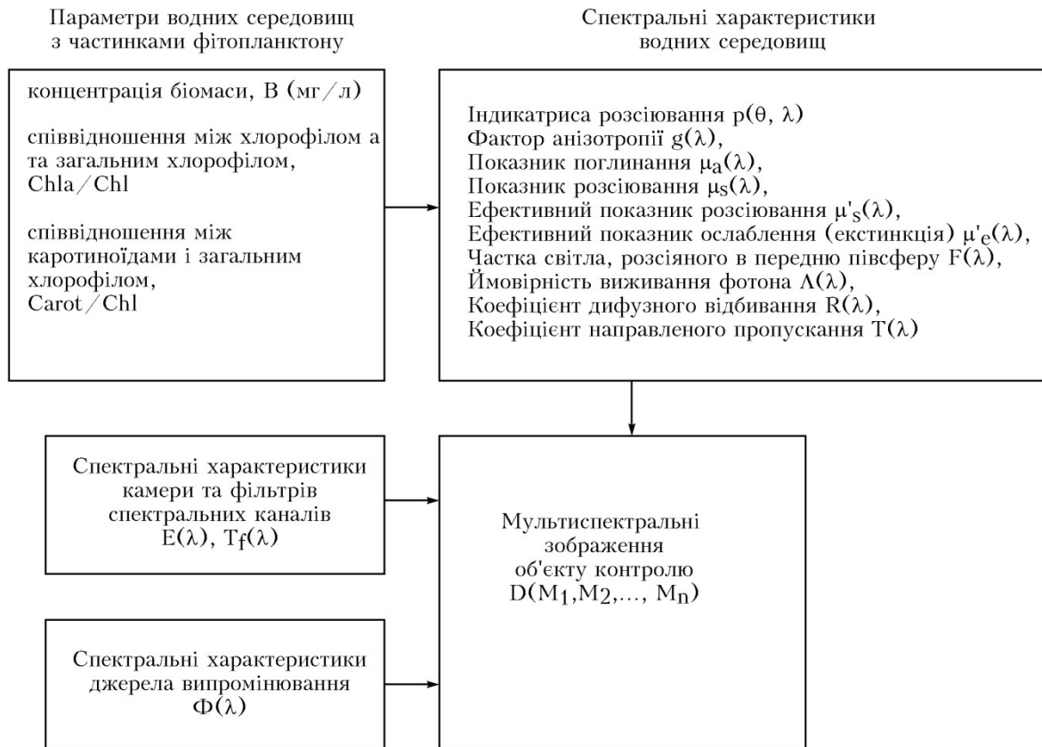
Рисунок 2.1 – Загальна схема розв'язку прямої задачі формування мультиспектральних зображень поверхні водного середовища з частинками фітопланктону
