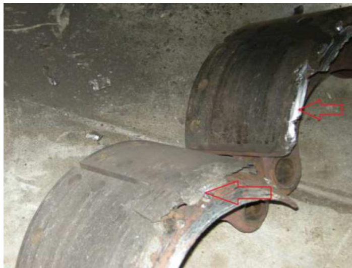
Рисунок 4.6 – Пошкодження гальмівних колодок
