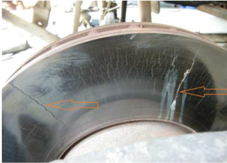
Рисунок 4.7 – Тріщина на гальмівному диску
