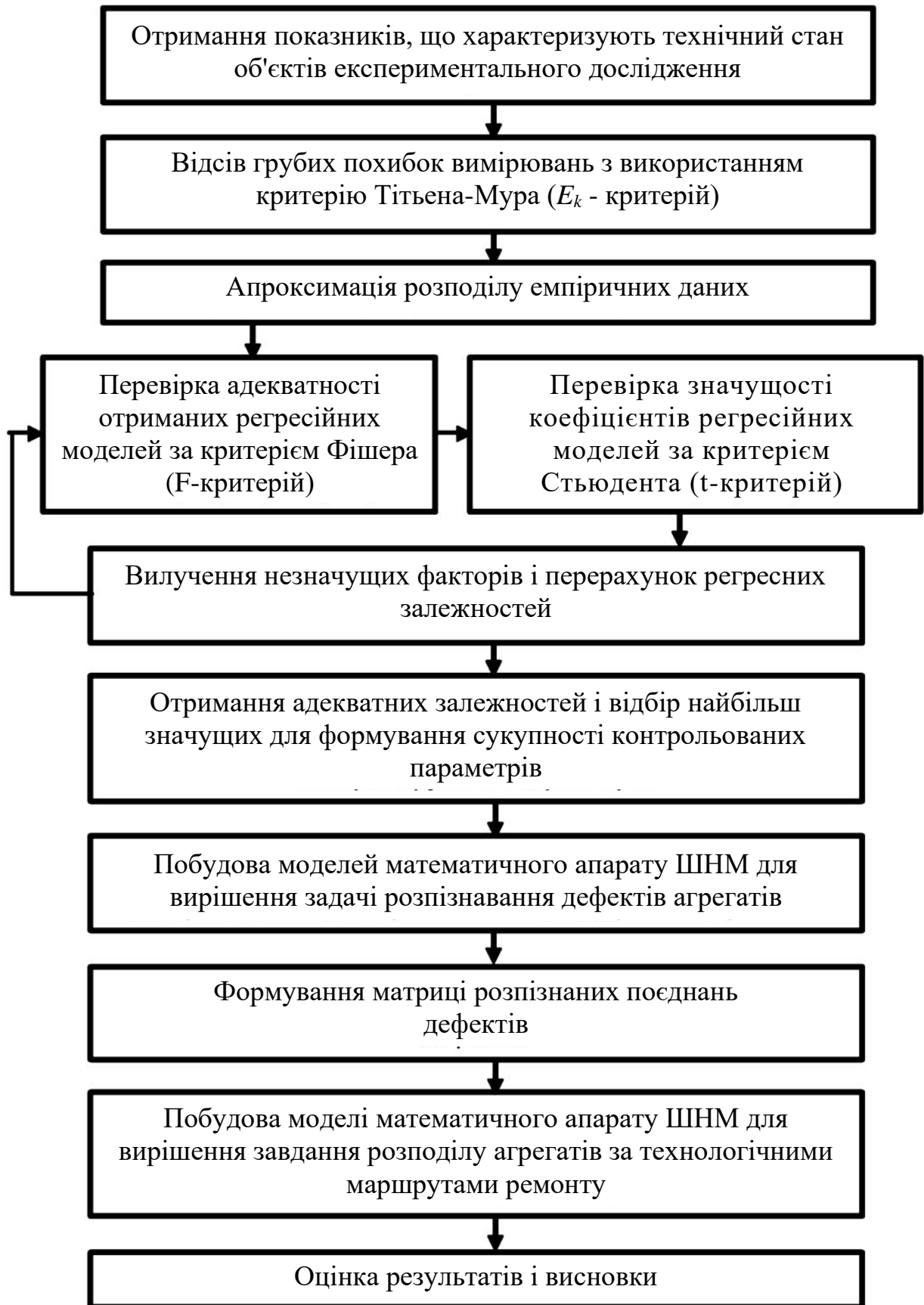
Рисунок Б.3 – Схема методики математичної обробки емпіричних даних для побудови моделей ШНМ
