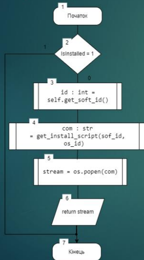
Рисунок Г.9 – Алгоритм встановлення програмного забезпечення
