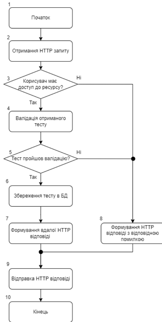
Рисунок 2.5 – Блок-схема алгоритму процесу збереження нового тесту
