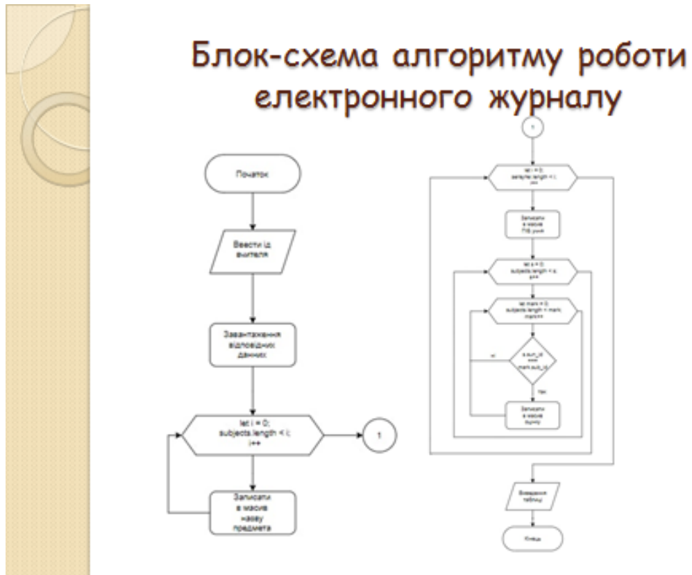
Рисунок Д.13 – Блок-схема алгоритму роботи електронного журналу
