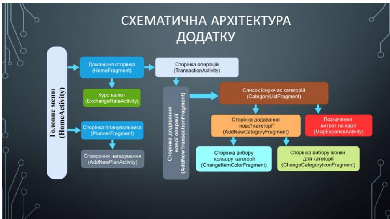
Рисунок Г.8 – Схематична архітектура додатку
