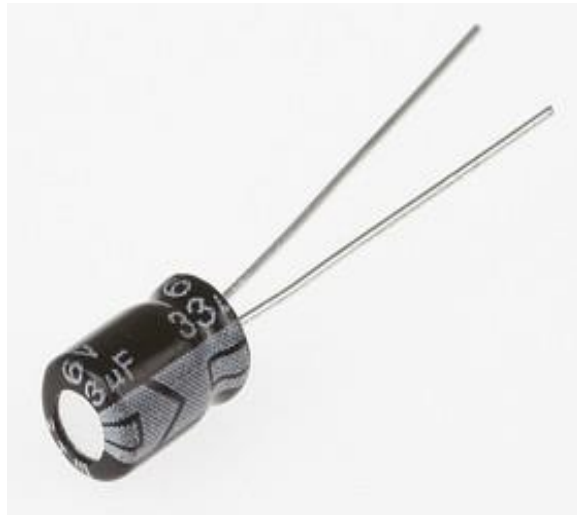
Рисунок 2.4 – Електролітний алюмінієвий конденсатор К50-35
