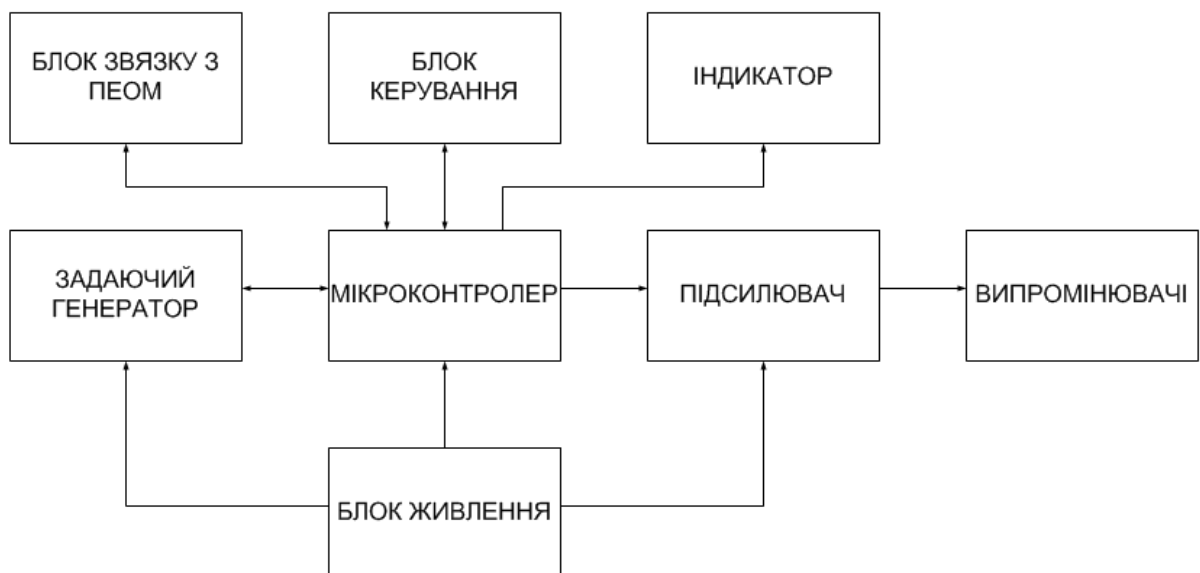
Рисунок 2.1 – Структурна схема приладу для перевірки стану зору
