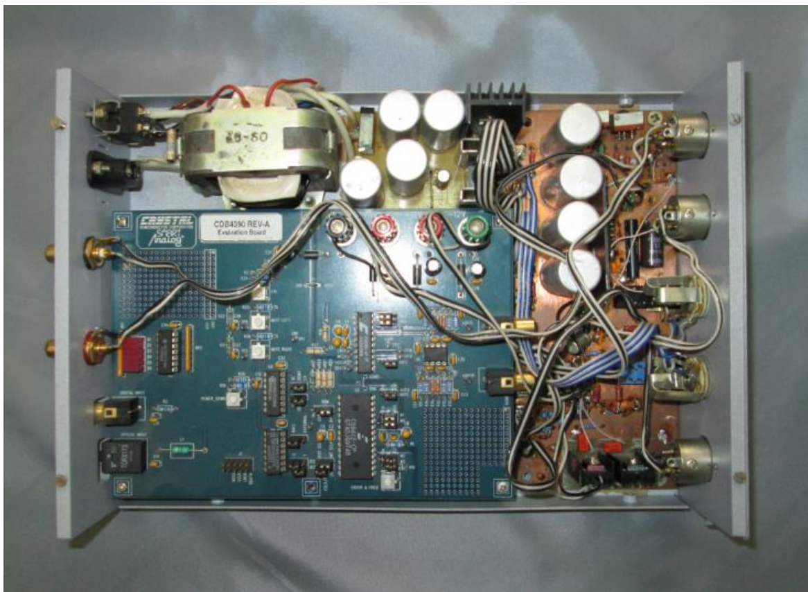
Рисунок 4.1 — Генератор аналогових сигналів для вимірювання низькочастотних каналів і трактів: а) вигляд зсередини
