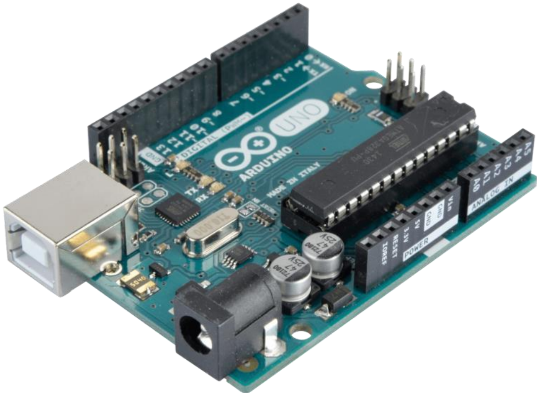
Рисунок 3.1 — Зовнішній вигляд плати контролера Arduino UNO R3 на базі мікроконтролера ATmega328
