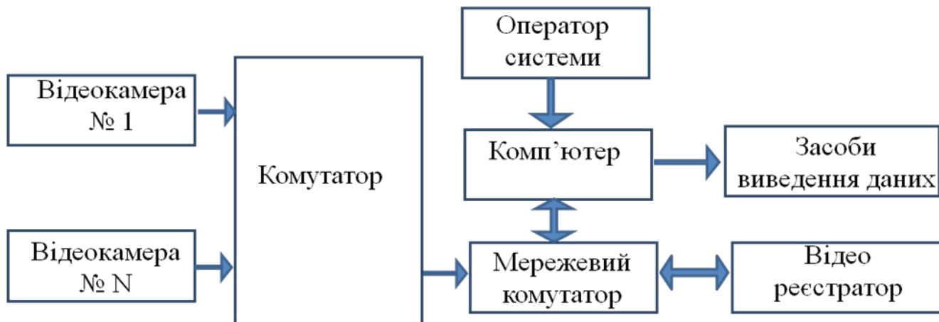
Рисунок Д.1 — Схема системи комп'ютерного відеоспостереження
