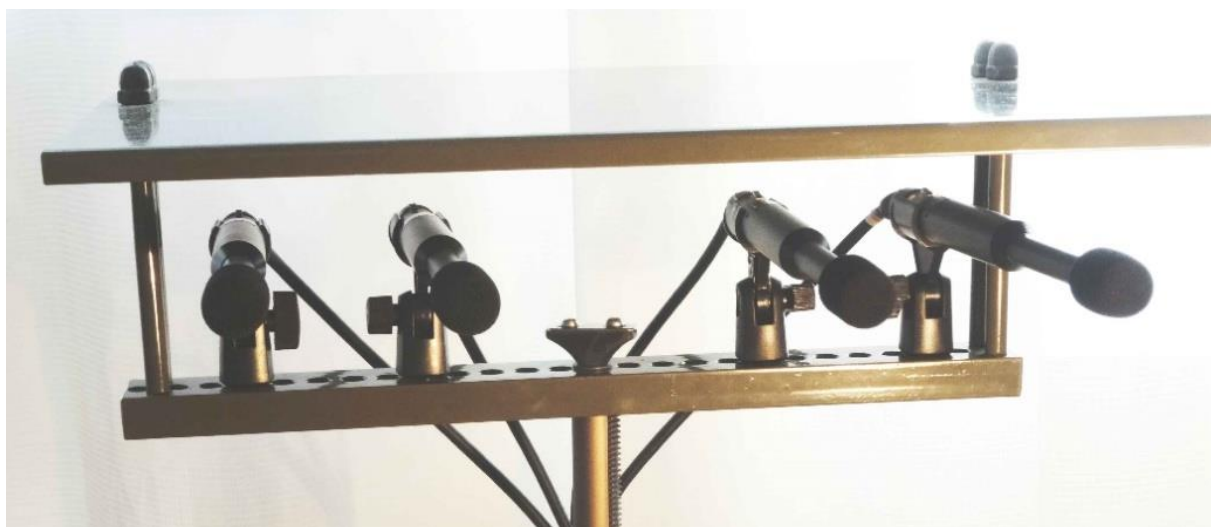
Рисунок 2.1 — Конструкція 4-канальної мікрофонної решітки з центральним проміжком
