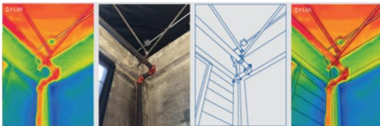
Рисунок 1.10 — Приклад роботи тепловізора Flir One Pro з технологією Flir MSX
