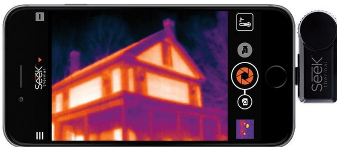
Рисунок 1.8 — Приклад роботи тепловізора Seek Thermal Compact
