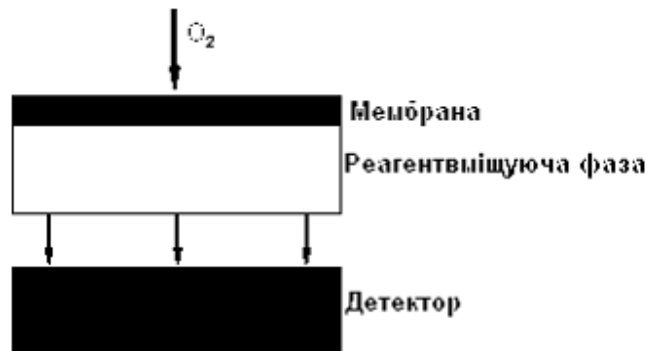
Рисунок 3.9 — Схема роботи необоротного волоконно-оптичного сенсора на кисень
