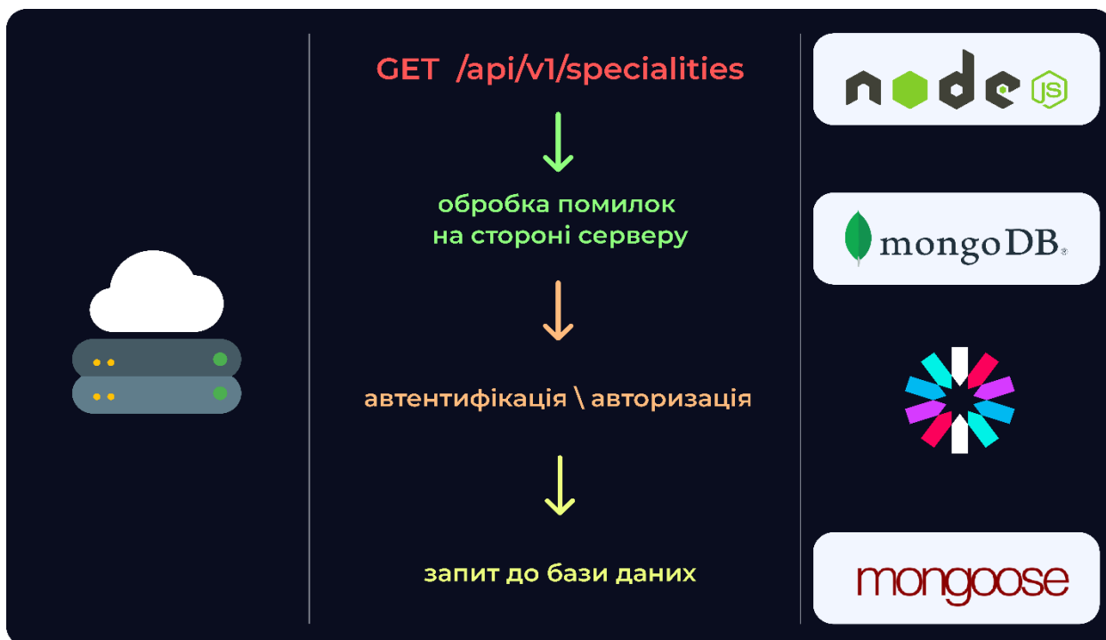
Рисунок Б.3 — Схема архітектури клієнт - сервер для програми, аутентифікації сервера, авторизації та аутентифікації.
