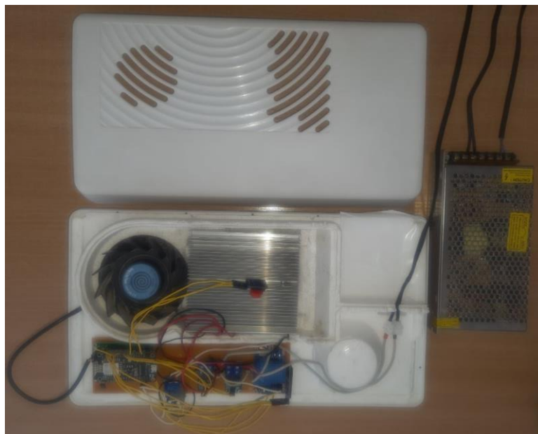
Рисунок 2.13 — Монтаж елементів у корпус кришки термоустановки
