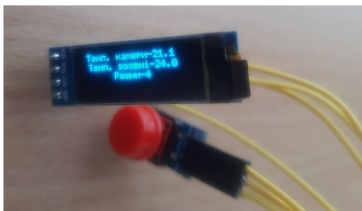
Рисунок 3.11 — фото екрану при ввімкненні режиму 4 кнопкою та опусканні температури до 21,1^{\circ}\text{C} , була 24^{\circ}\text{C} .
