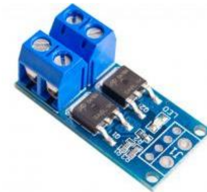
Рисунок 2.5 — Модуль силового ключа на двох MOSFET AOD4184
