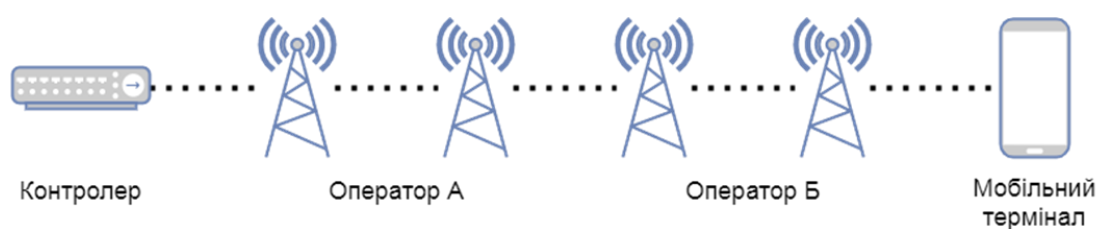
Рисунок 2.1 — Схема ланцюгової передачі повідомлень через мережу GSM
