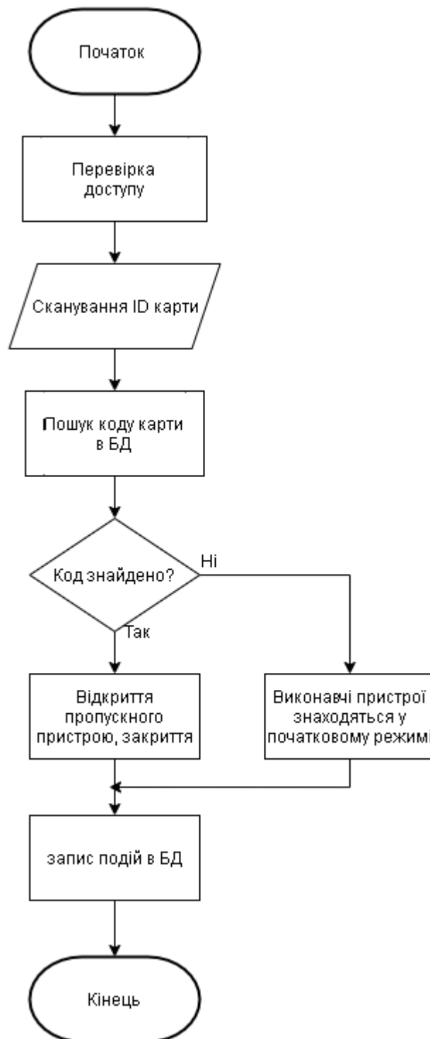
Рисунок 3.2 — Блок-схема алгоритму ідентифікації карти
