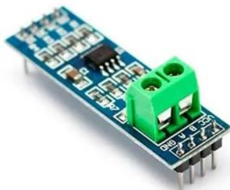
Рисунок 3.4 - Модуль TTL - RS485 для Arduino
