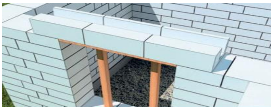
Рисунок. 2.4 – Фрагмент влаштування збірно-монолітної перемички з газобетонних U-блоків
