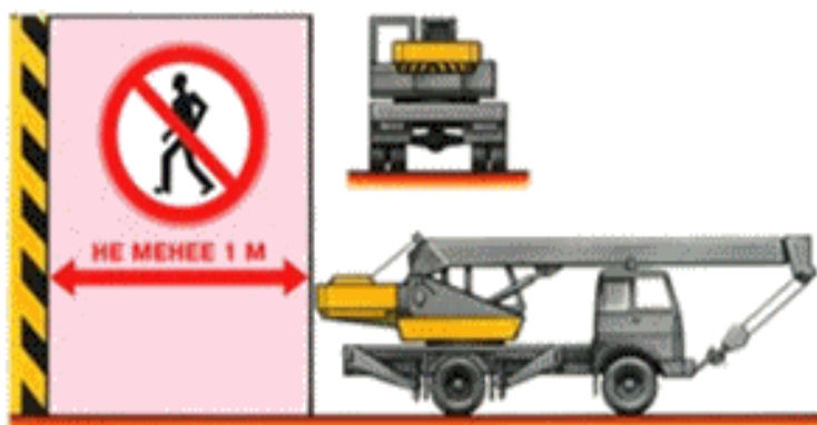
Рисунок 6.2 – Схема установки крана при наявності перепон.
