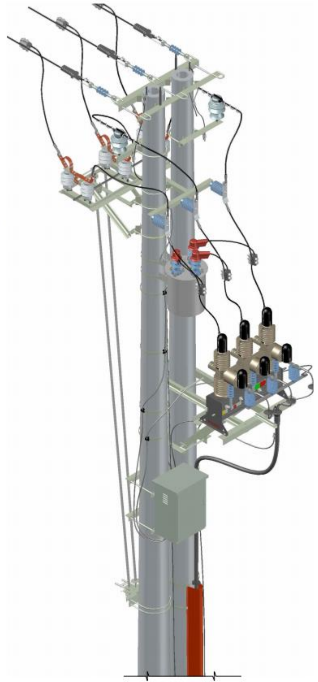
Рисунок 2.7 – Перехідна анкерна опора із встановленням реклоузера
