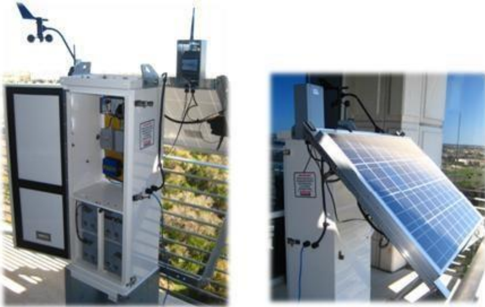
Рисунок 2.9 – Система обліку параметрів генерації ФЕС в модулях LabVIEW DSC
