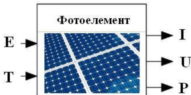
Рисунок 2.1 – Вхідні та вихідні дані для моделювання фотоелемента
