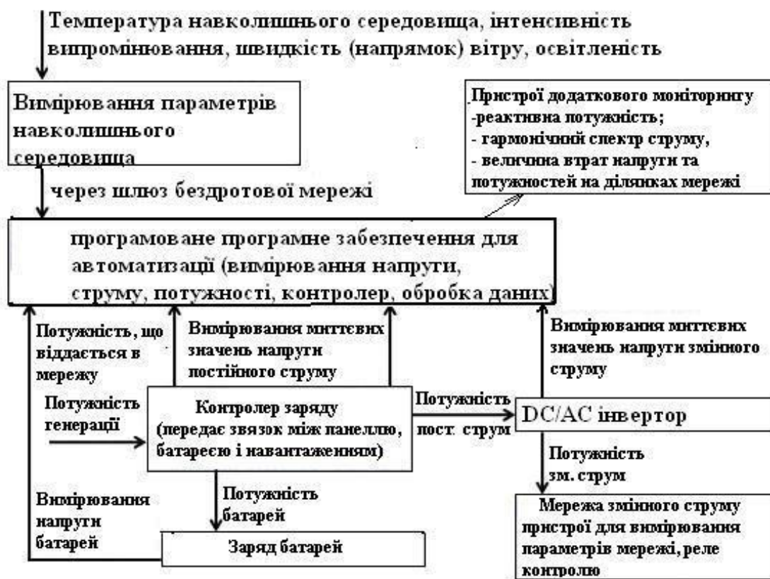
Рисунок 2.8 – Блок-схема типової системи моніторингу ФЕС
