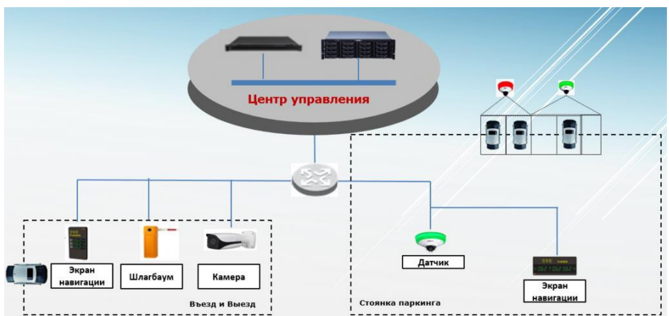
Схема системы автоматизованого управління парковкою "Dahua" [https://leater.com/services/sistema-upravleniya-parkovkoy.html]
