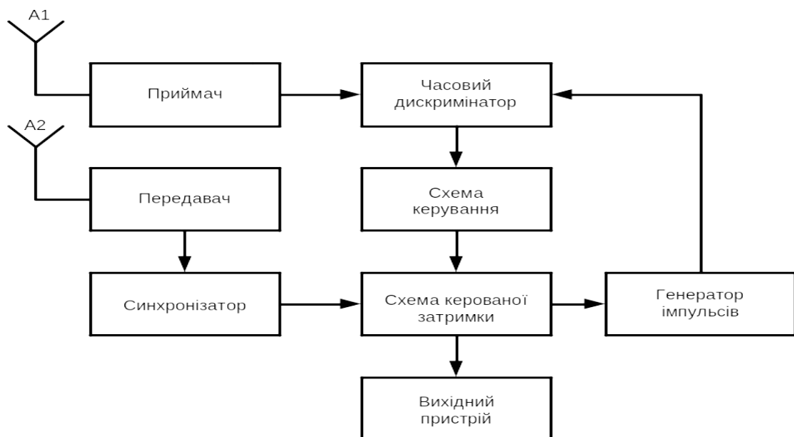
Рисунок 1.4 – Структурна схема системи при застосуванні імпульсного безперервного режиму
