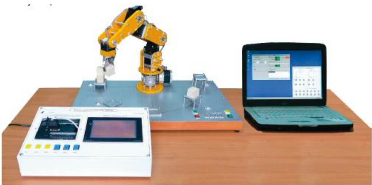
Рисунок 1.1 - Комп'ютеризований багатофункціональний лабораторний стенд «Засоби автоматизації й управління робота-маніпулятора»
