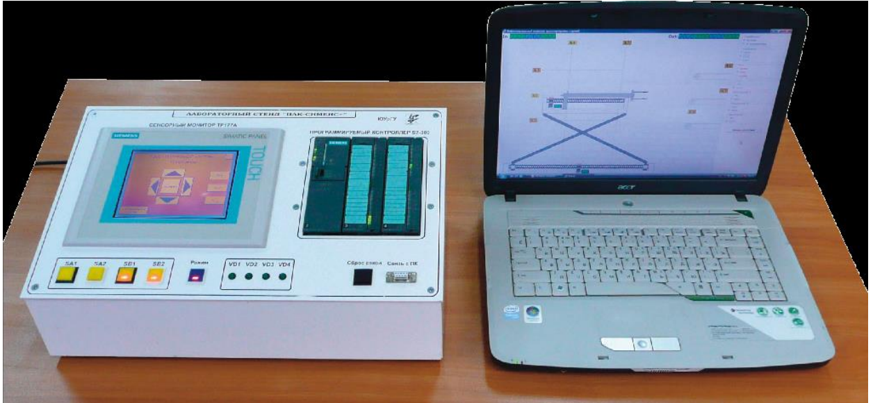
Рисунок 1.2 - Комп'ютеризований лабораторний стенд "Мікропроцесорна система керування кроковим двигуном"
