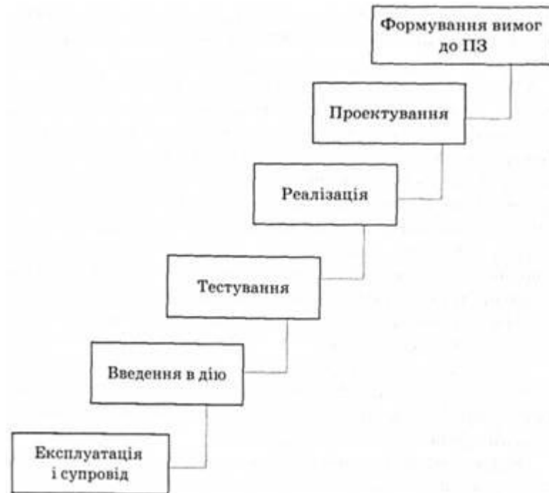
Рисунок 3.1 – Водоспадна модель розробки баз даних
