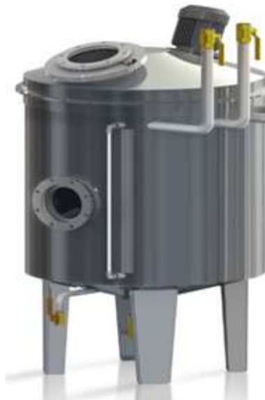
Рисунок 3.1 – Установка змішуюча швидкодіюча для виробництва антисептиків та інших складних багатокомпонентних речовин на ПАТ «Монфарм»
