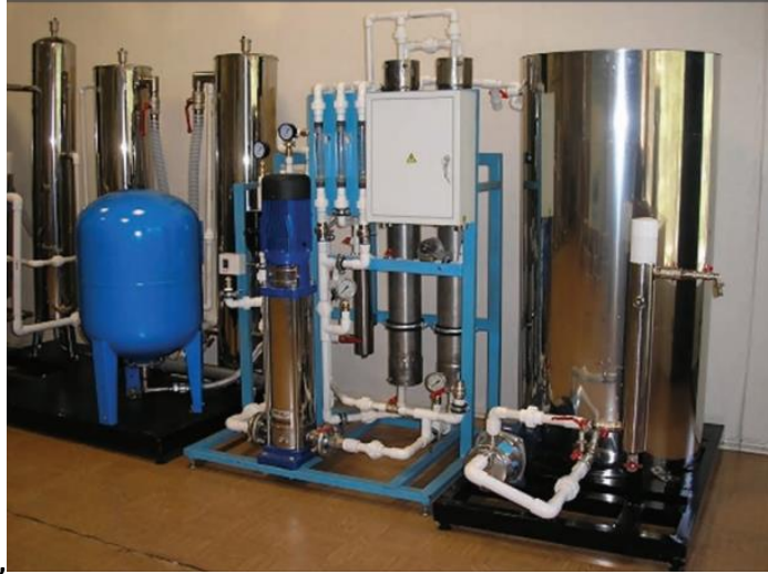
Рисунок 1.1 – Автономна установка колективного користування продуктивністю 0,5 м 3 /год
