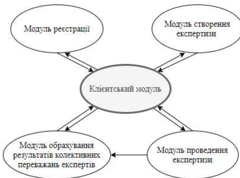
Рисунок 2.4 – Структурна схема взаємодії серверних модулів та клієнтської частини
