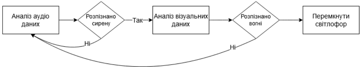
Рисунок 3.3 – Діаграма алгоритму роботи системи
