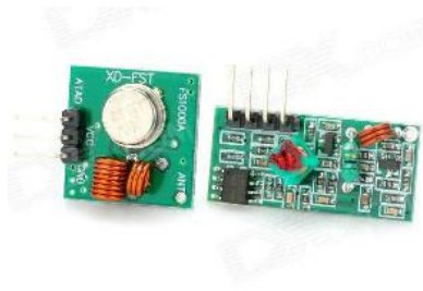
Рисунок 2.5 – Типовий радіо-модуль для Raspberry Pi
