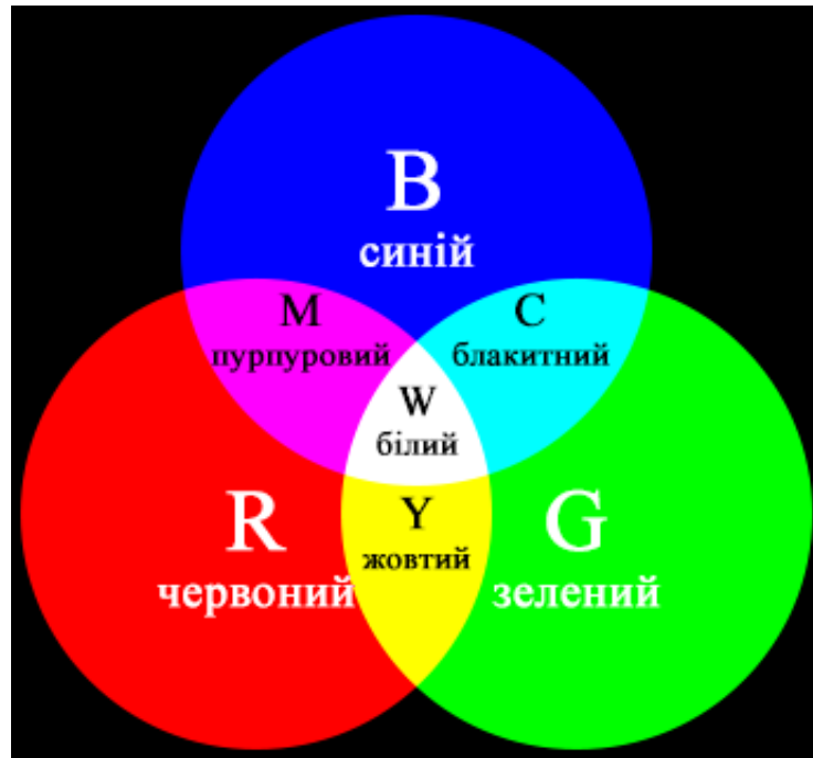
Рисунок 1.2 – Білий колір як результат змішування світла трьох кольорів (червоного, зеленого та синього)
