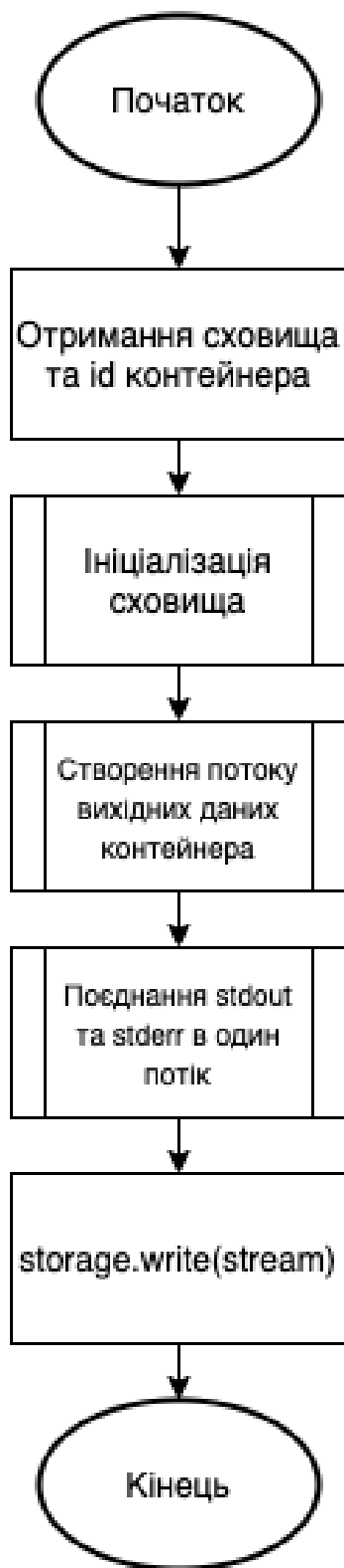
Рисунок 2.5 – Блок-схема алгоритму логування вихідних даних контейнера
