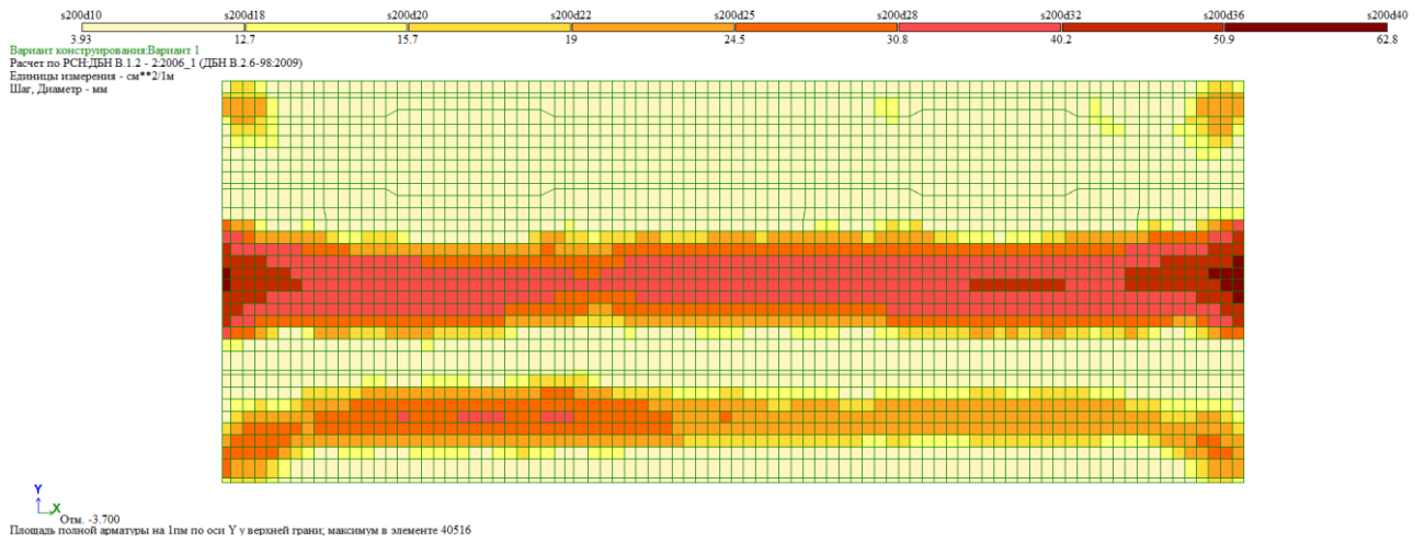
Рисунок Б.3 – Розрахункове армування верхньої грані плити ростверку вздовж осі Y від основних сполучень навантажень
