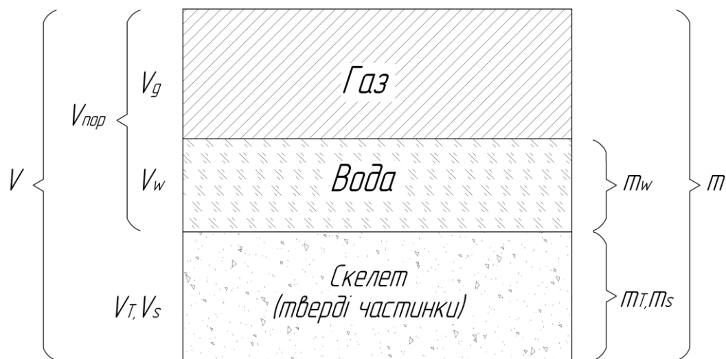
Рис.1.4 – Графічна схема ґрунту як трифазної системи (спрощена ідеалізована модель К. Терцагі)
