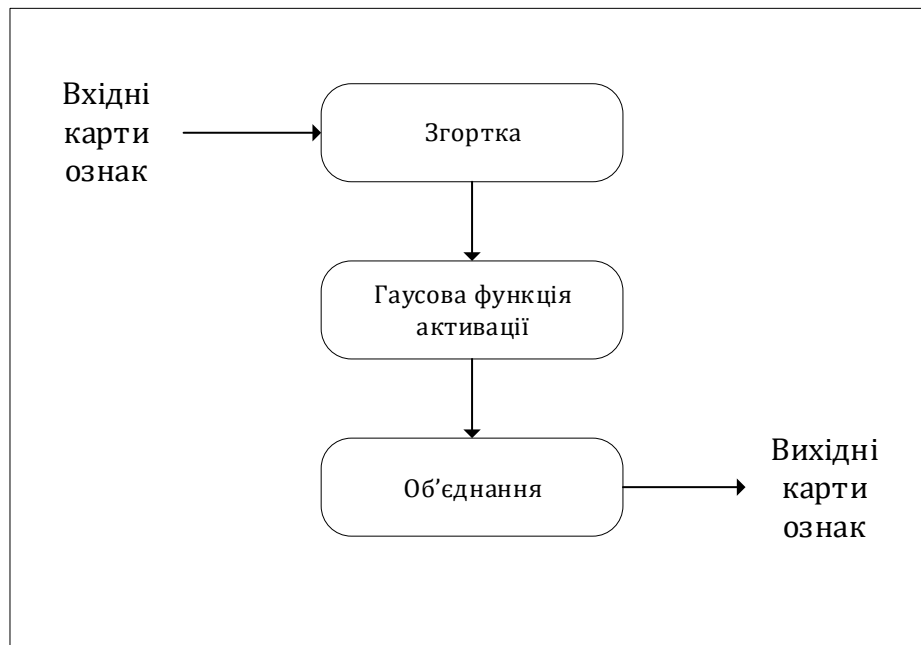
Рисунок 2.4 – Компоненти згорткового шару в моделі, включаючи згортку, гауссівську нелінійність та усереднене об'єднання
