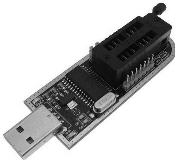
Рисунок 2.5 – Зовнішній вигляд USB-UART перехідника на базі чіпу CH341A
