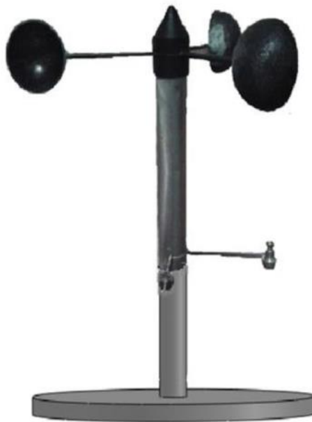
Рисунок 4.5 - Механічна частина анемометра
