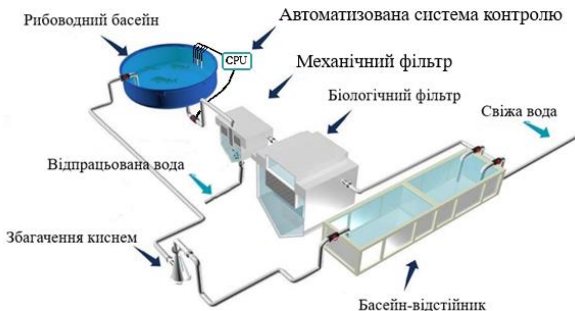
Рисунок 1.1 Схема роботи автоматизованої системи контролю параметрів води в рибоводному басейні
