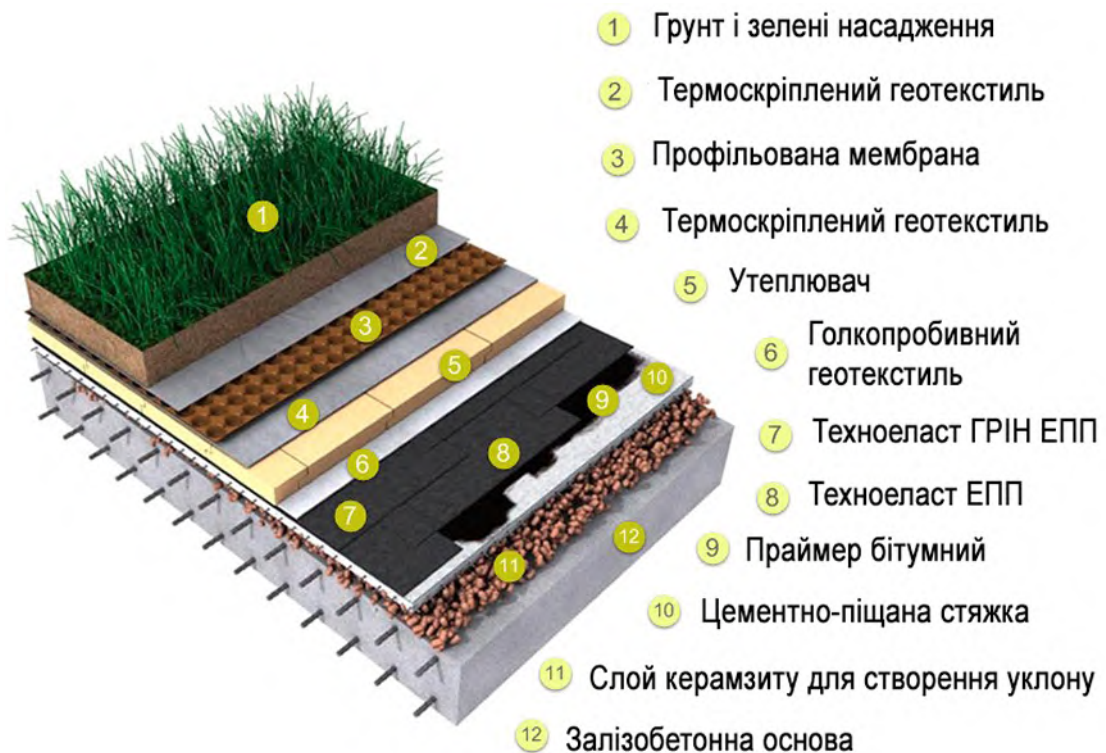
Рисунок 1.10 – Конструкція зеленої покрівлі
