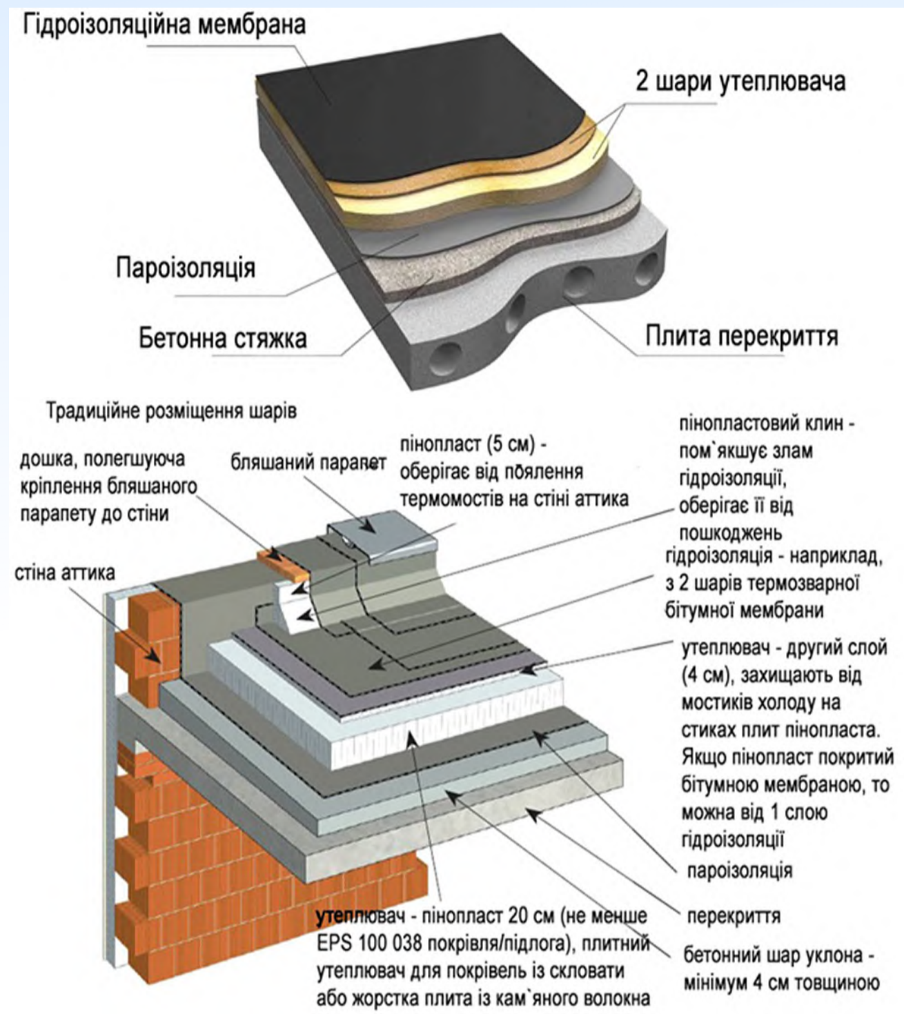
Конструкція традиційної плоскої покрівлі
