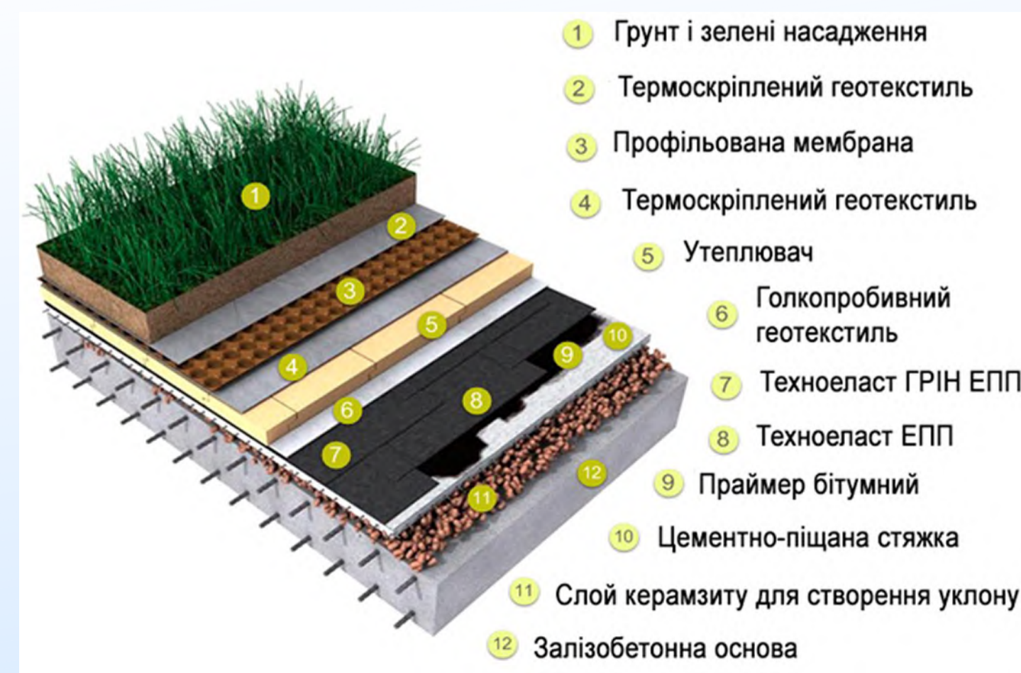
Конструкція зеленої покрівлі
