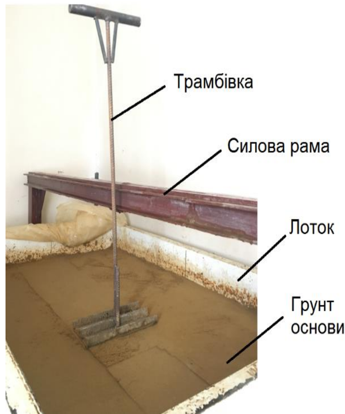
Підготовка ґрунтової основи
