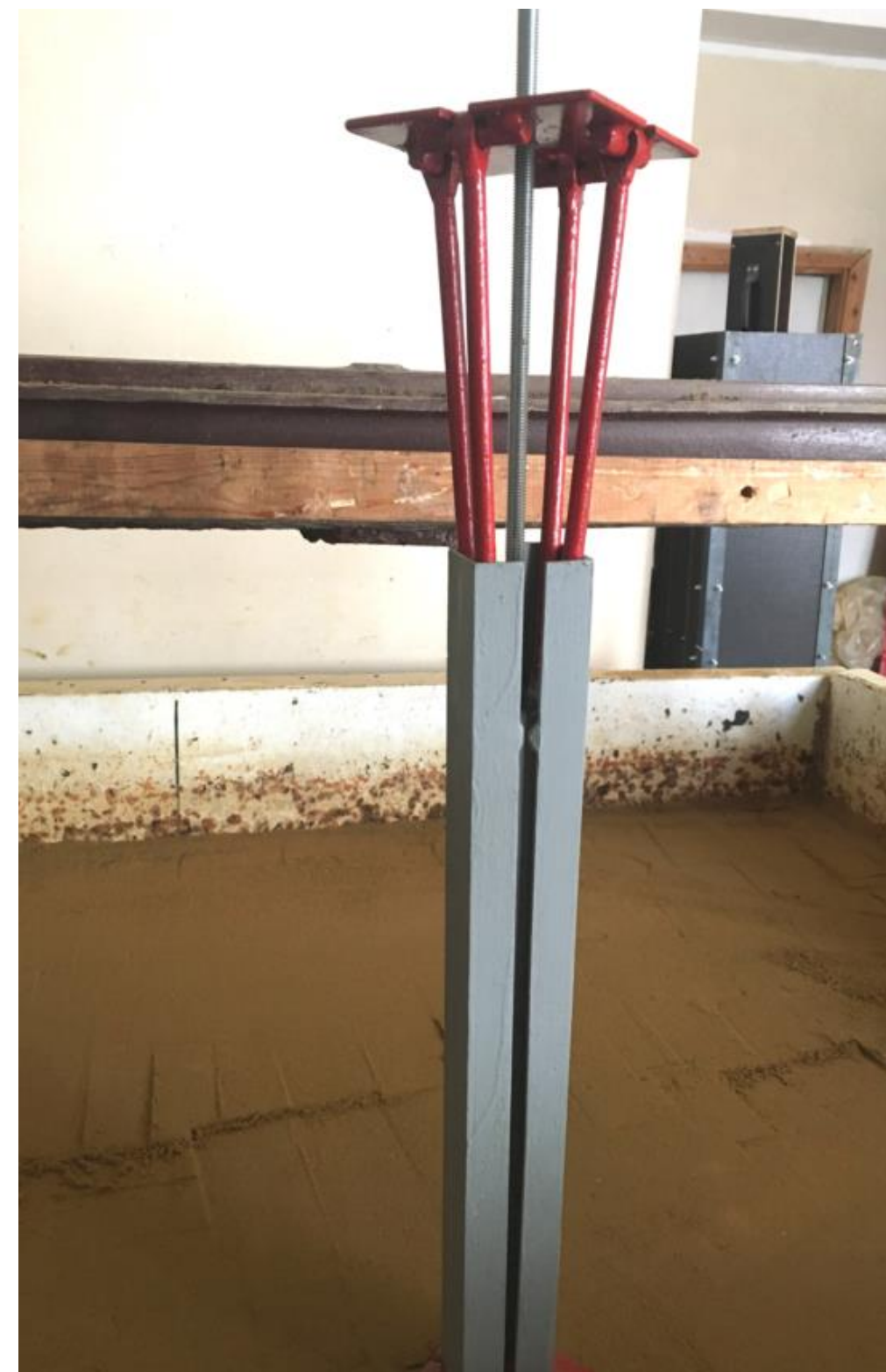
Робочий орган перед опусканням в свердловину
