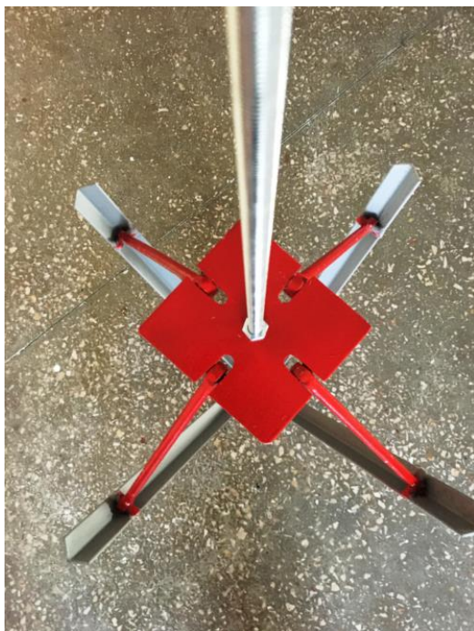
Рис. 2.2 – Робочий орган і модель фундаменту
