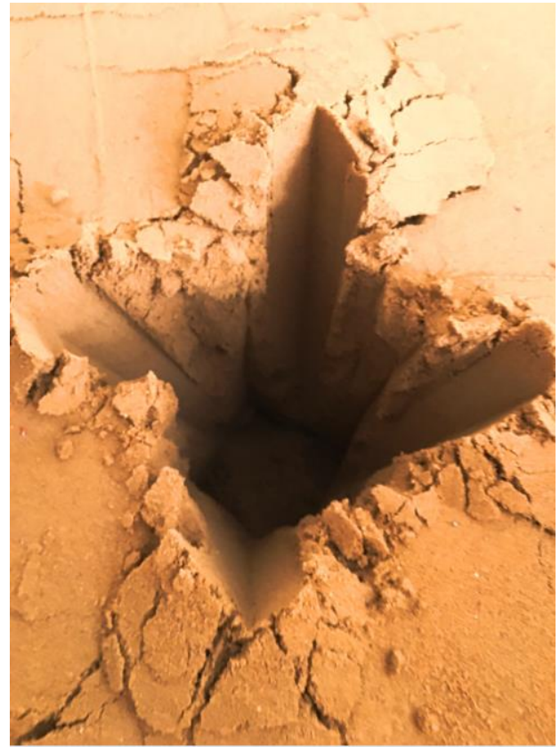
Рис. 2.8 – Утворений котлован з ущільненими стінками
