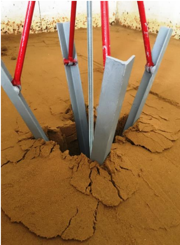
Рис. 2.7 – Випирання ґрунту в процесі ущільнення стінок
