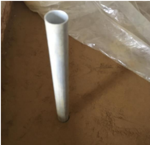
Рис. 2.4 - Влаштування свердловини в ґрунтовій основі
