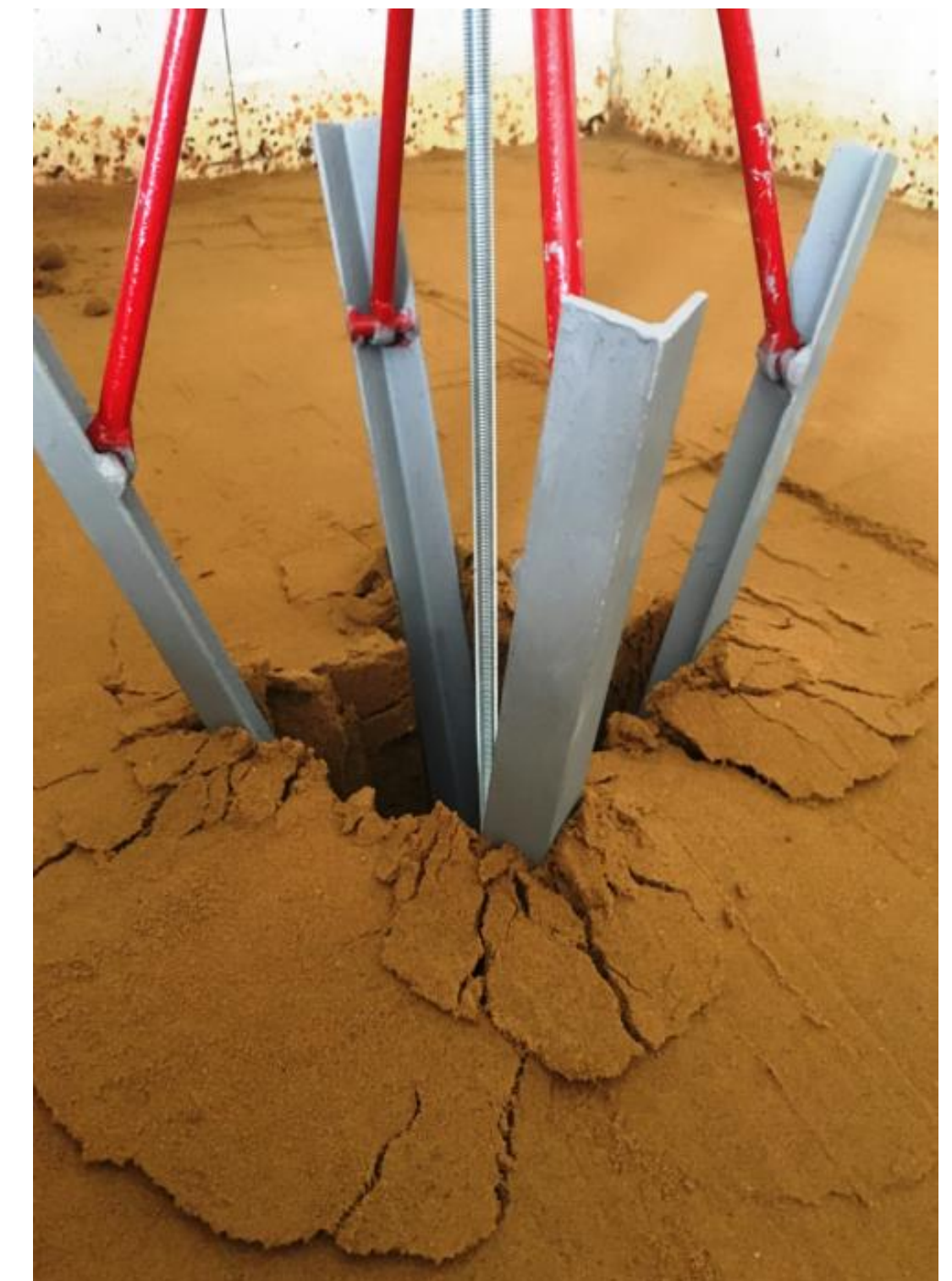
Робочий орган в процесі ущільнення ґрунту
