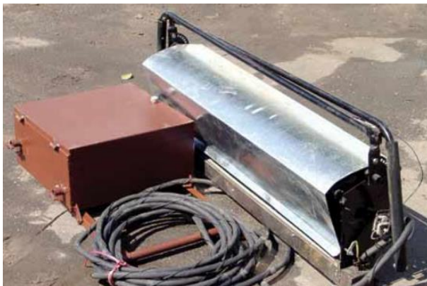
Рис. 1.8 - Машина «Луч» з трьома нагрівальними елементами в корпусі 1 - прикаточний валик; 2 - опромінювач; 3 - рулонний покрівельний матеріал; 4 - розплавлений бітум; 5 - інфрачервоне випромінювання; 6 - основа покрівлі; 7 - зона нагріву основи і наклеюваного матеріалу.
