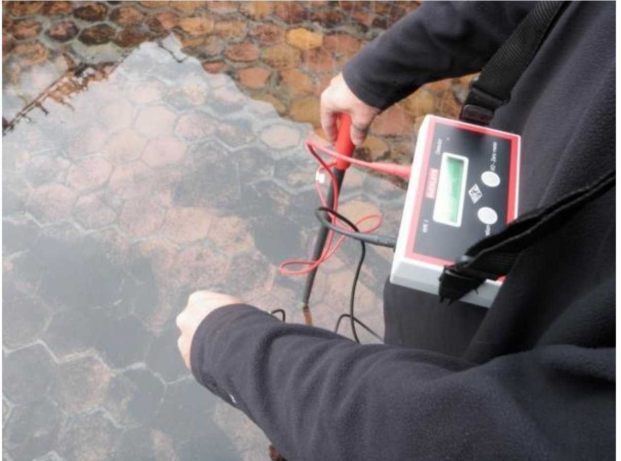
Рис. 2.8 – Процедура проведення лектровекторної картографії
