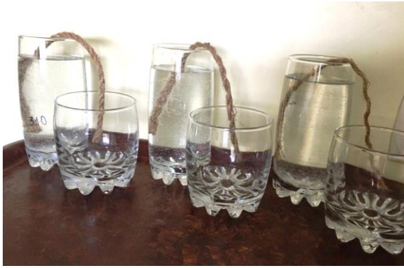
Рис. 3.5 – Водовідведення з використанням капілярного ефекту а) – початкова стадія; б) – кінцева стадія
