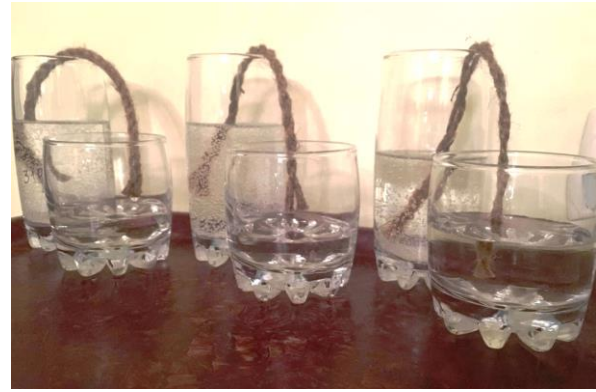
Рис. 3.5 – Водовідведення з використанням капілярного ефекту а) – початкова стадія; б) – кінцева стадія
